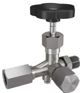
Manometer-Absperrventil DVGW, DIN 16271, Zapfen x Spannmuffe x Prüfzapfen M20 x 1,5
