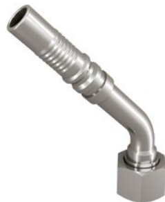
Pressnippel DKR 45°, Dichtkegel mit 60° Konus, Dichtkopf BSPP Gewinde Pressnipple DKR 45°, sealing cone 60°, sealing head thread BSPP
