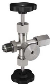
Manometer-Doppelabsperrventil, DIN 16272, Zapfen x Spannmuffe x Prüfflansch 40 x 5 mm, Material: Messing, 1.0460, 1.4571
