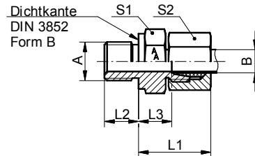
Gerade Einschraubverschraubung, Einschraubgewinde BSPP mit Dichtkante Form B, leichte Reihe
